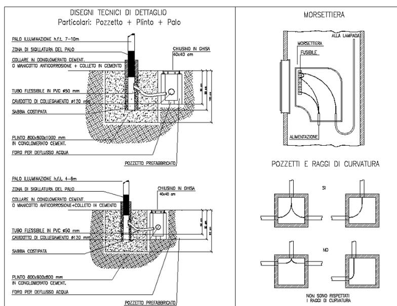
Figura 85. Schemi di massima, sostegni, pozzetti e giunzioni.
